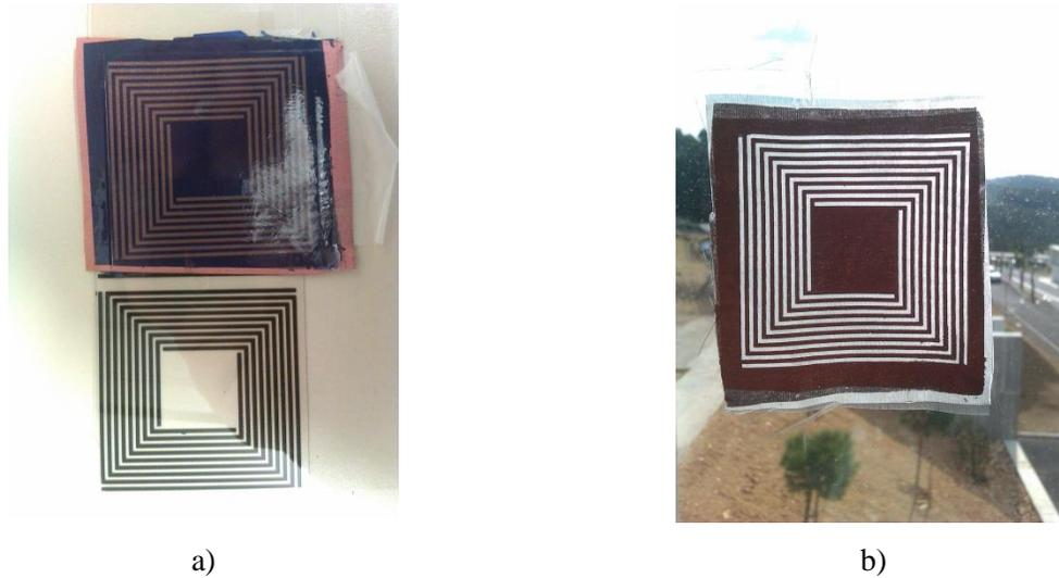
*Figure II-21 – Photographies d'un échantillon d'électrotextile Taffetas Copper gravé avec l'utilisation de film photo-résistant Dupont™ Riston® : (a) avant gravure, (b) après gravure.*
