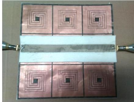
Figure IV-22 – Prototype d'un réseau de 3\*3 cellules Langley modifiées avec ligne suspendue en transmission.
