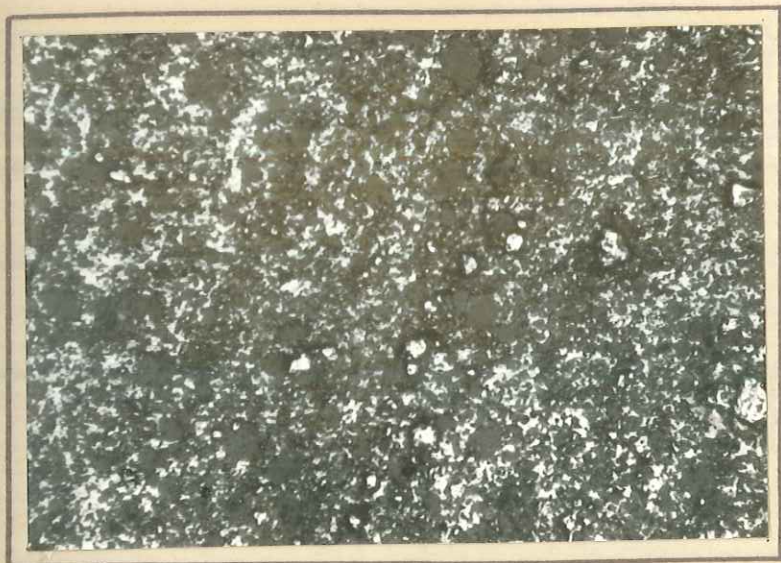
Photo N° 5. Imprégnation de chalcopyrite dans les schistes encaissants. Grains de pyrite résiduelle. (Lumière naturelle. Grossissement Leitz - 16)
