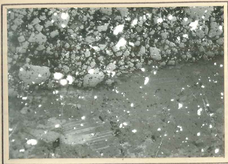
Photo N° 5. Venue cuivreuse tardive. (Lumière polarisée, Grossissement Leitz - 5,6)
