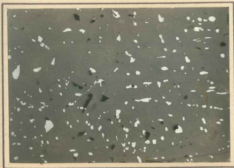
Photo N° 6. Chalcopyrite en exsolution dans de la blende. (Lumière naturelle. Grossissement Leitz - 16)
