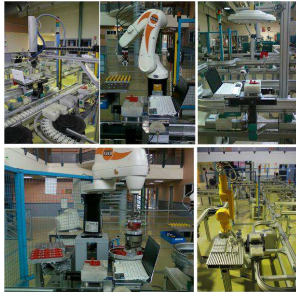
Figure 6.3– Chargement, Robot 6 axes, Poste de Vision, Robot 4 axes et Bras robotisé
