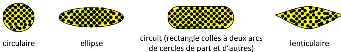
Figure 2.1 : sections transverses idéales de toron
