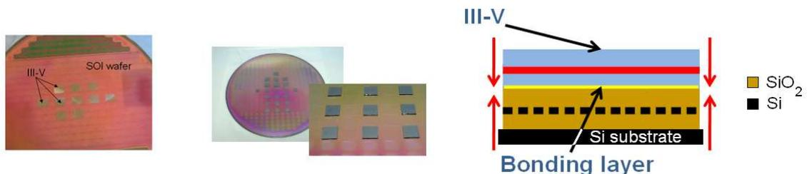
Figure 6—Schéma conceptuel de l'intégration photonique sur silicium utilisant l'approche technologique du collage moléculaire des matériaux III-V sur silicium micro-nano-structuré. A gauche, des photos montrent les premiers essais de collage en vignettes des couches InP/InGaAsP sur SOI.
