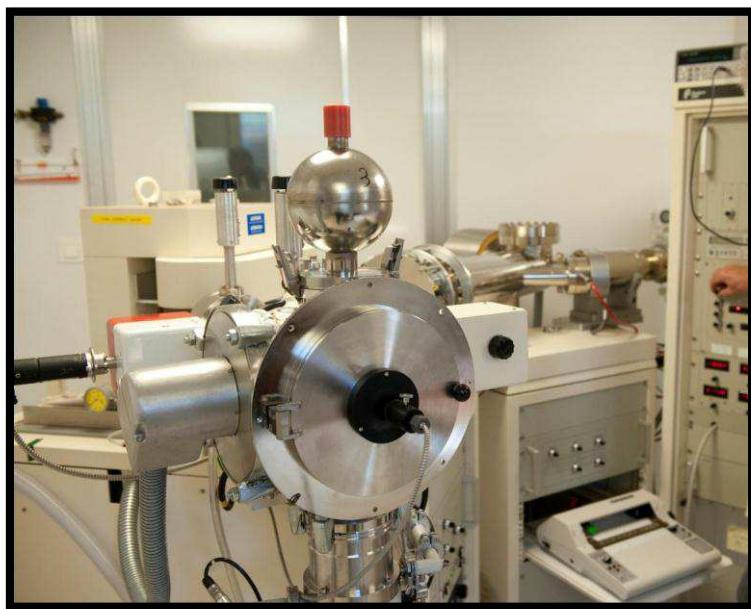
*Figure 7 - Spectromètre de masse à source solide (TIMS) modèle MAT 262 du brgm. La partie en premier plan correspond à la source, ensuite nous pouvons apercevoir l'aimant au second plan à gauche et enfin le tube et la partie « collection/détection » à l'arrière plan à droite.*
