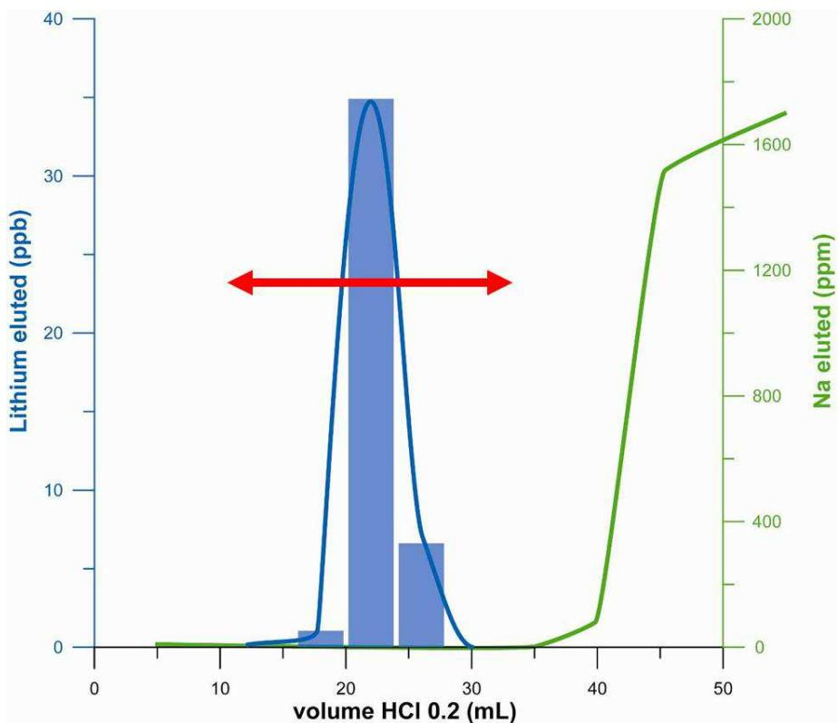
*Figure 12 - Courbes d'élation du lithium et du sodium en milieu acide HCl 0.2N pour une matrice eau de mer. Seule la fraction comprise entre 10 et 35 mL est collectée (flèche rouge) et contient uniquement le lithium. A noter la différence d'échelle significative entre le lithium et le sodium.*
