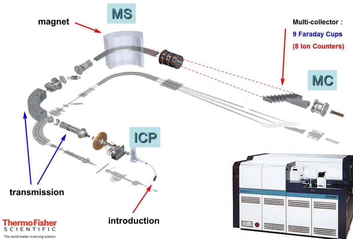
Figure 19 - Schéma de fonctionnement du MC-ICP-MS Neptune.
