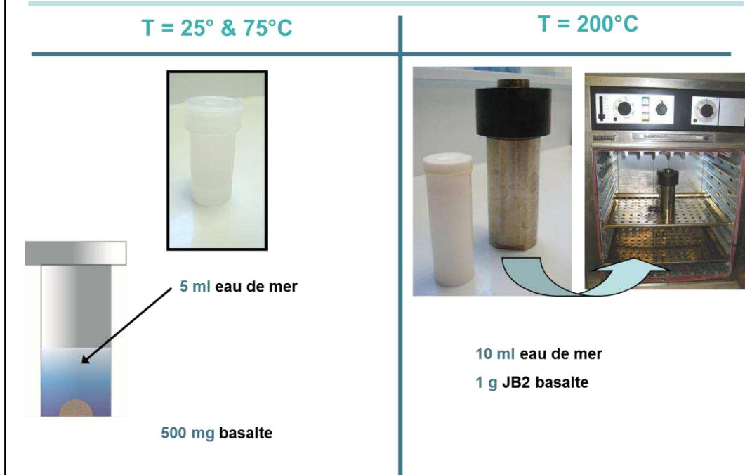
Figure 40 - Dispositif expérimental pour les interactions à  $25^\circ$ ,  $75^\circ$  et  $200^\circ\text{C}$  (BRGM).
