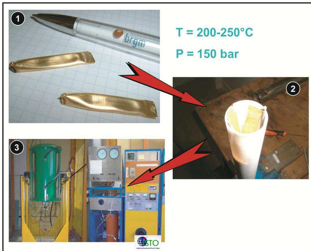
Figure 41 - Dispositif expérimental pour les interactions à  $200^\circ$  et  $250^\circ\text{C}$  (ISTO).
