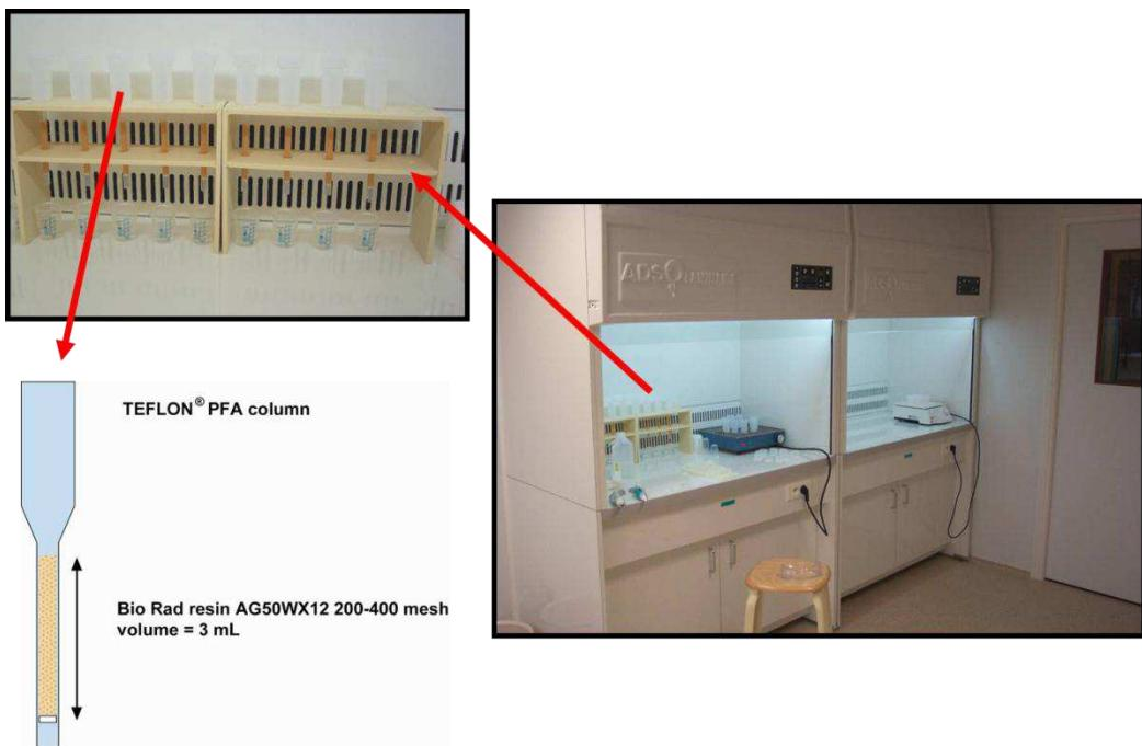
*Figure 10 - Colonnes en Téflon contenant de la résine cationique, ces colonnes se trouvent dans une hotte à flux laminaire, elle-même située dans une salle blanche.*
