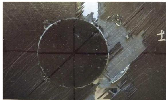
Figure IV.15 Faciès de rupture des réparations par les patches [45/-45]<sub>s</sub>
