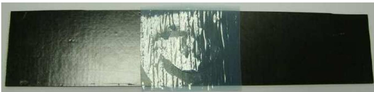
Figure IV.5 Mise en position des patches durs avec un film démoulant [4]
