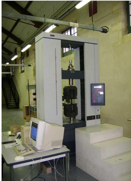
Figure II.3 Machine statique ADAMEL DY36
