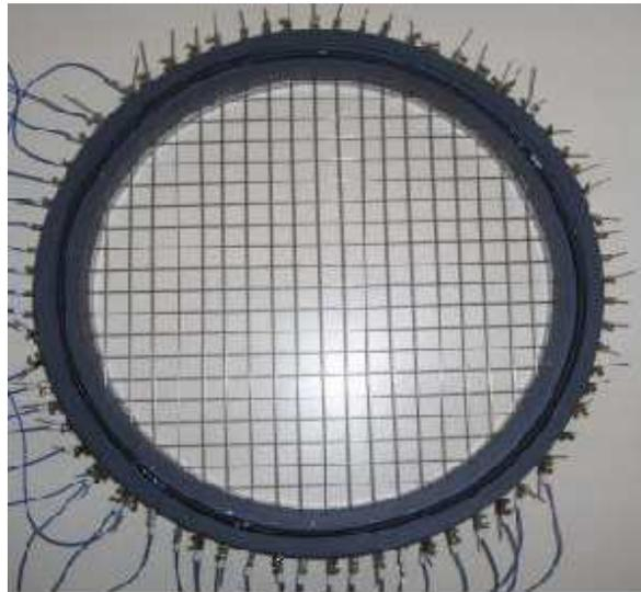
FIGURE 1.3 – Vue du dispositif de tomographie à fils avant implantation
