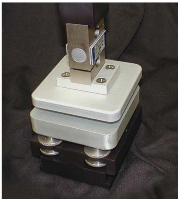
**Figure 17 :** Type de cellule majoritairement utilisée pour l'analyse de profil de texture (Evrat-Georgel, 2008).
