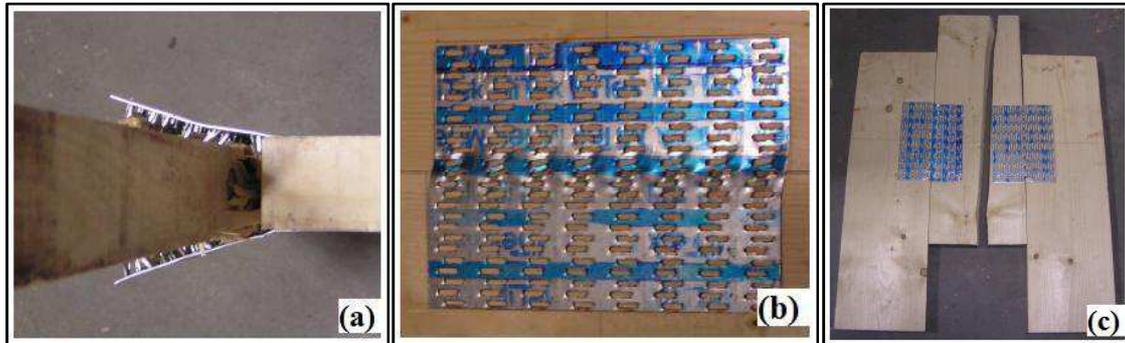
**Figure III. 1 :** Modes de défaillance des assemblages bois par plaques métalliques embouties : (a) arrachement des dents de la plaque du bois, (b) plastification de la plaque, (c) rupture d'un élément bois [140]
