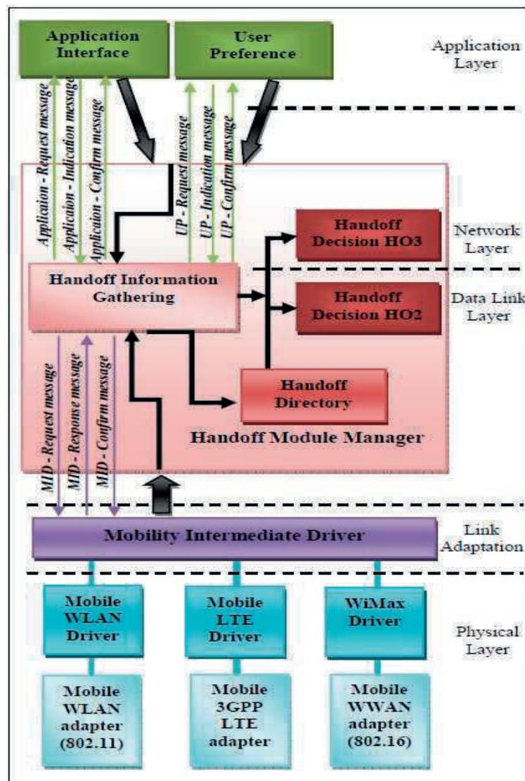
Figure 1.7 - Architecture du terminal dans un environnement hétérogène [49].
