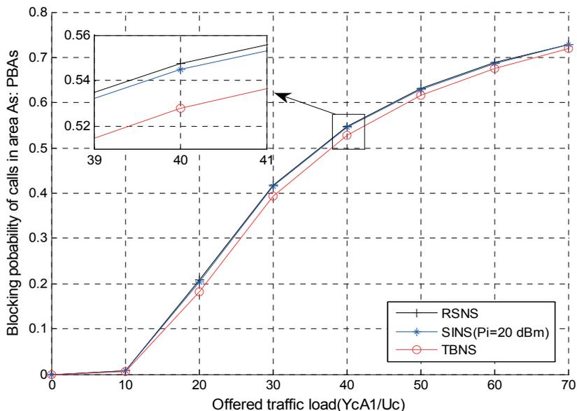
Figure 5.5 - Probabilité de blocage dans la zone  $A_5$ .
