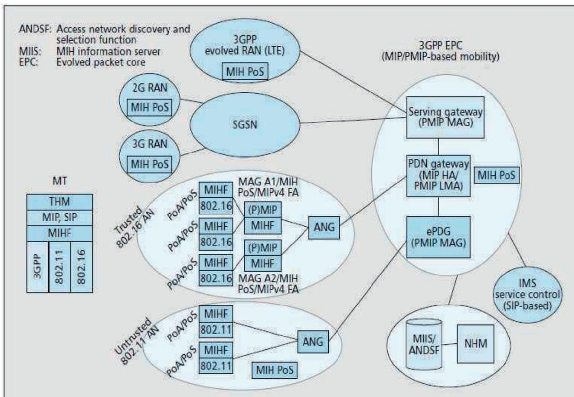
Figure 1.6 - Architecture du système évolué 3GPP [47].
