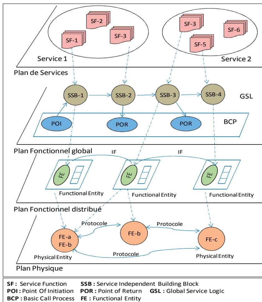
Figure 1.1 - Modèle conceptuel du réseau intelligent.
