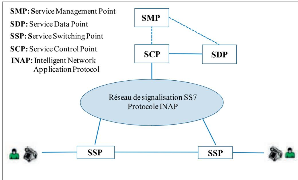
Figure 1.2 - Architecture physique simplifiée du réseau intelligent.
