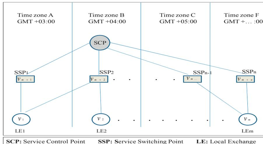
Figure 2.1 - Configuration générale d'un RI à grande échelle.
