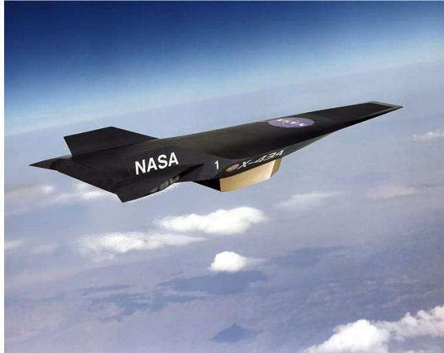
Figure 2 : X-43 Scramjet, avion sans pilote de la série Hyper-X, largué d'un avion-porteur, NASA, 2004
