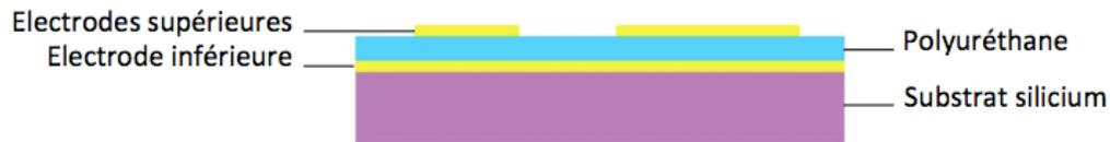
**Figure 3-25 : Schéma de profil des puces pour les mesures électrique.**
