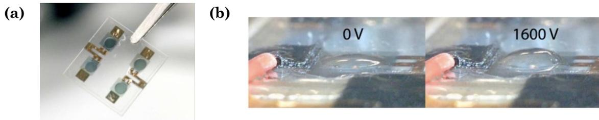
**Figure 1-29. Photographies d'une puce avec 4 actionneurs en PDMS de 3mm de diamètre (a) et test sur une des membranes à 0V et 1600V (b)(une pression de 125 Pa est appliquée sous la membrane pour favoriser la direction du déplacement) [51].**
