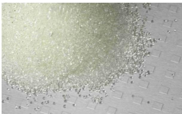
Figure 2-1. Pastilles de polyuréthane.
