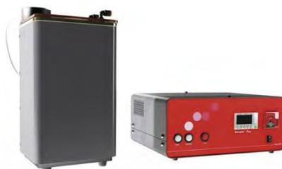
Figure V.1. Bioruptor de Diagenode utilisé pour la formation de SUVs.
