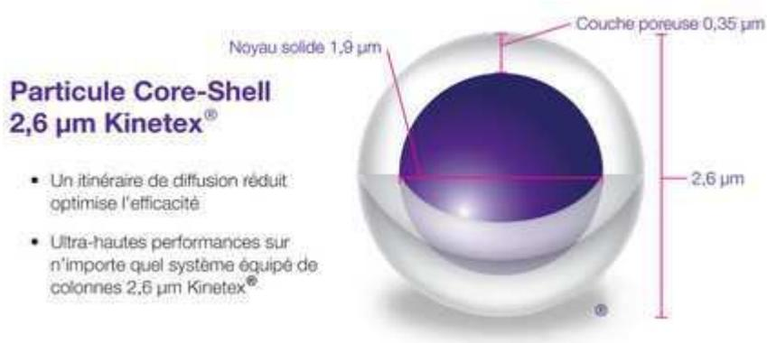
Figure 32 - Les sphères de silice Kinetex<sup>®</sup>(Phenomenex)
