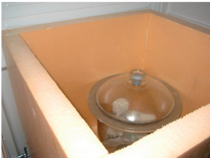
**Figure 6-8** Dessiccateur dans la boîte en Styrodur
