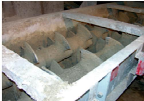
**Figure 1-11** Malaxage avant compactage-vibrage
