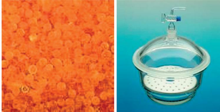
**Figure 3-2** Photographies de gel de silice à gauche et d'un dessiccateur à vide à droite
