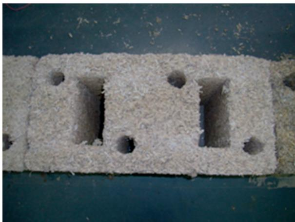
**Figure 4-4** Bloc préfabriqué de béton de chanvre vu de dessus
