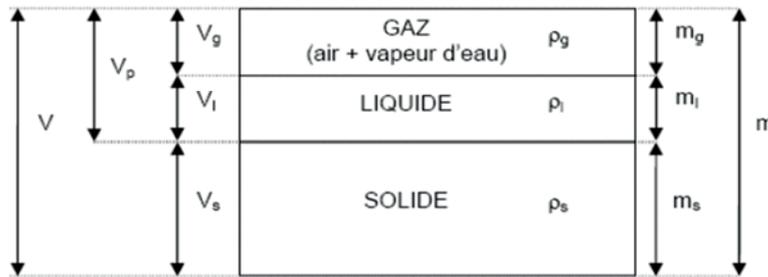
**Figure 2-6** Diagramme des phases d'un milieu poreux non saturé<sup>18</sup>
