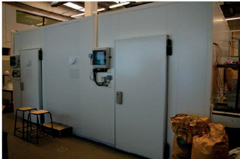
Figure 1-23 Chambre biclimatique (photographie de celle du LIMATB)
