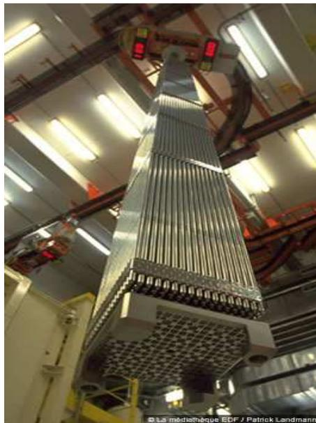
FIGURE 3.1 – Assemblage du combustible.
