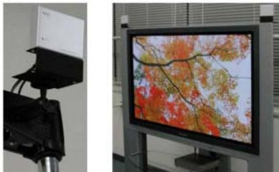
FIGURE 1.8 – Photo du transmetteur (à gauche) et des deux récepteurs placés en haut de la télévision (à droite).
