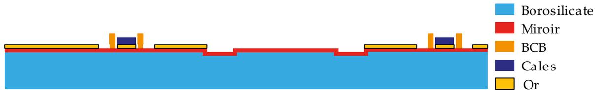
Le wafer est ensuite nettoyé, et le joint de scellement en BCB est formé par étalement à la tournette puis insolation UV et développement. Pour cette étape, si l'étalement à la tournette du BCB ne nous donne pas un joint étanche en fin d'assemblage (nécessaire pour la découpe à la scie diamantée, car elle est refroidie par eau), nous pourrions utiliser des résines sous forme de films secs (cf. partie 6.2 p169).
