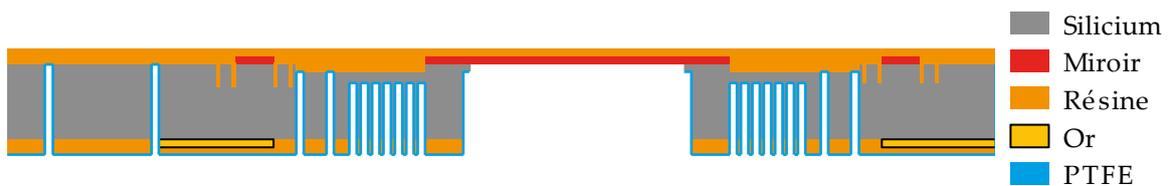
Le wafer est décollé du wafer support. La fine couche de silicium et les motifs temporaires sous les miroirs sont ensuite gravés chimiquement en atmosphère gazeuse par  $\text{XeF}_2$ . Cette technique de gravure du silicium très sélective par rapport à la silice permet un arrêt strict de la gravure sur la membrane.
