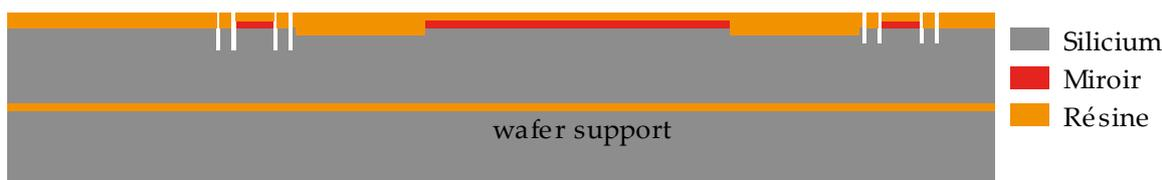
Une seconde gravure DRIE (facultative) a été prévue pour faire des tranchées de  $30\ \mu\text{m}$  de profondeur. Situées en face avant et à la périphérie de la structure, ces tranchées serviront à faciliter la compression et à absorber l'excédent du joint de scellement adhésif en Benzocyclobutène (BCB) entre les wafers. Ces tranchées devraient aussi augmenter la résistance mécanique au cisaillement du joint BCB pendant l'étape de découpe à la scie diamant.
