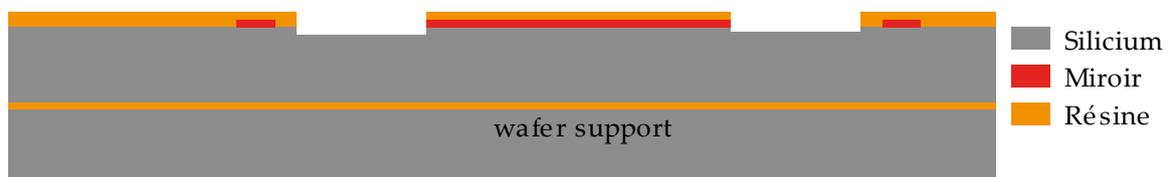
Le wafer est ensuite monté à l'aide d'une couche de graisse thermique sur un wafer support, cela pour permettre de le charger dans un bâti de gravure ionique réactive profonde (DRIE : Deep Reactive Ion Etching) du silicium. Cette précaution a été jugée nécessaire car, à l'intérieur du bâti de gravure DRIE, le wafer est maintenu en place par des clamps exerçant une pression qui risque de briser les wafers trop fins (300-400 µm d'épaisseur).
