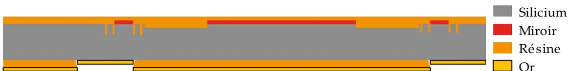
Des contacts électriques Au/Ti sont ensuite déposés, et délimités par lift-off sur la face arrière. La résine en face avant sert à protéger les miroirs contre les rayures et poussières.
