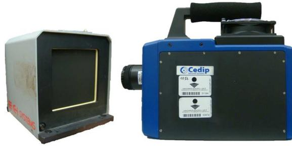
*Figure 3.7 Dispositifs infrarouges (corps noir et caméra IR)*
