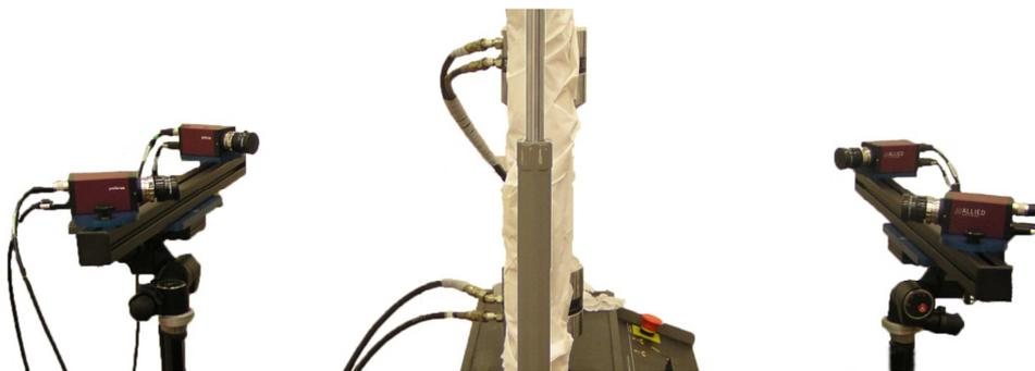
*Figure 3.4 Positionnement des bancs de stéréo-corrélation*
