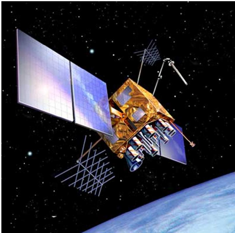
Photo 1: vue d'artiste d'un satellite GPS en orbite autour de la Terre à 20200 km d'altitude.
