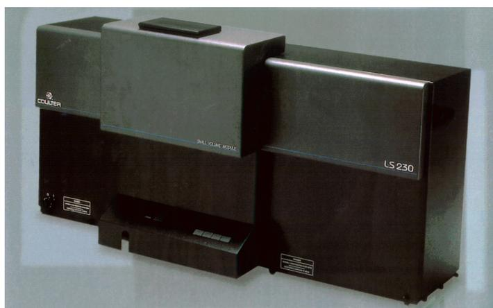
Figure II.1. Photos d'un granulometre laser type coulter LS
