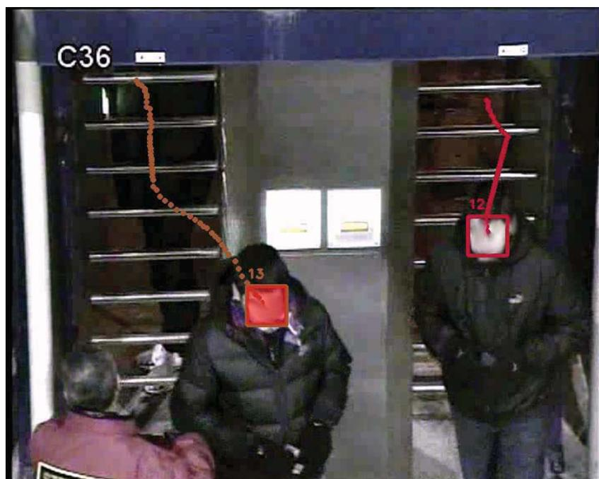
FIGURE 6.3 – Exemple de suivi de visages. Sur cet exemple, deux visages sont suivis. Un numéro de piste est associé à chaque visage : 12 et 13. Les points colorés représentent les trajectoires des deux visages. Les visages des deux personnes entrantes ont été floutés
