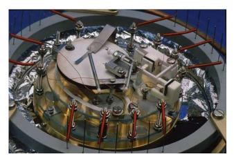
Figure 1-3 : Réplique du premier microscope en champ proche : le STM construit par Binnig et Rohrer en 1981 chez IBM à Zurich.
