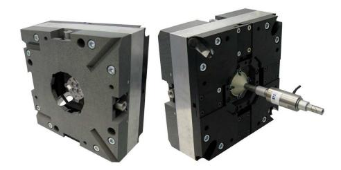
Figure 5-29 : Assemblage final de la platine Z et de la platine à pantographe tel qu'il est utilisé sur l'AFM métrologique.
