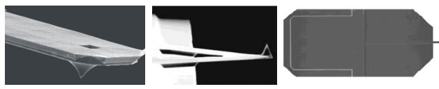
Figure 1-9: Exemple de leviers de pointe AFM et support de pointe.
