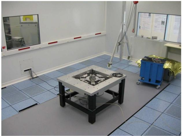
Figure 4-23 : Intégration de l'AFM métrologique dans la salle propre d'expérimentation. Les électroniques de commande et le poste de pilotage sont situés dans la salle de contrôle adjacente.
