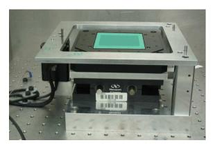
Figure 2-3 : Partie inférieure de l'AFM - les platines de translation permettent de déplacer l'échantillon sous la pointe AFM. La tête AFM est posée de façon isostatique (montage trait-point-plan) au dessus de l'échantillon et l'approche pointe-surface est assurée à l'aide d'un moteur pas à pas.
