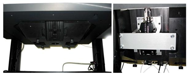
Figure 4-8: Intégration des interféromètres différentiels sur le berceau.
