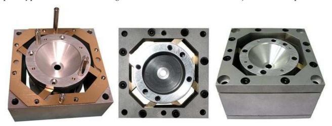
Figure 5-20 : Mise en place des feuilles de chrysocale et des mors sur le prototype de la platine Z (gauche) et assemblage final du prototype.
