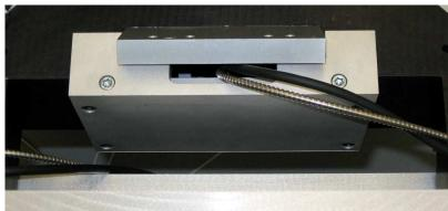
Figure 4-12 : Protection des interféromètres différentiels à l'aide de caissons en aluminium autour de chaque interféromètre.
