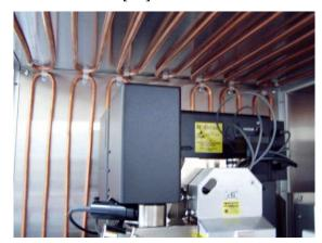
Figure A-13 : L'AFM métrologique du CMS (à gauche) et son caisson actif de régulation de la température (à droite).
