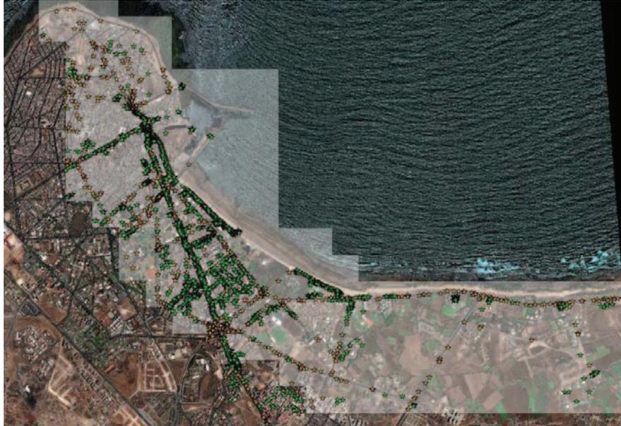
Figure 85. Géoréférencement des véhicules en stationnement (vert) et en déplacement (orange) présents sur l'image QuickBird du 15 juillet 2009 à 11h34. Utilité pour le calcul des densités de débris potentiels par tronçon de rue (Leone et al., 2012).
