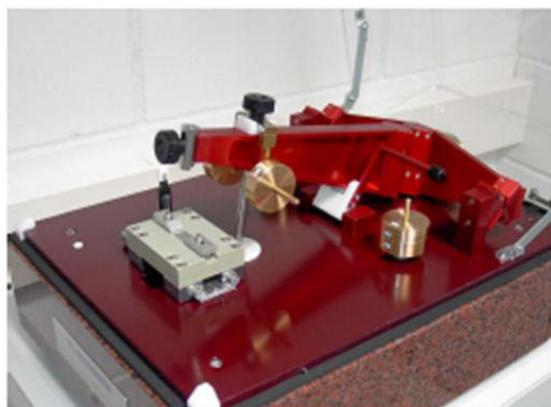
Figure 150 : Photographie du tribomètre
