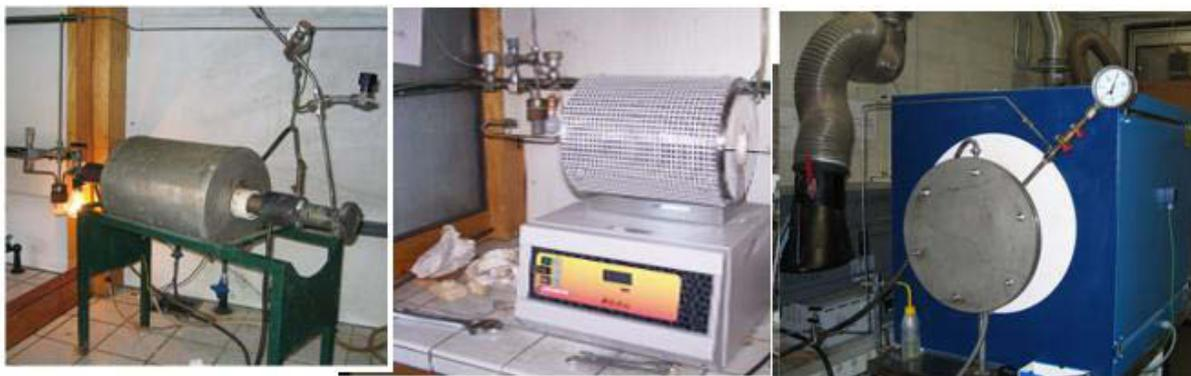
Figure 99 : Photos des installations à différentes échelles : deux fours à l'échelle du laboratoire (gauche et milieu) et un à l'échelle « pré-industrielle », le « micropilote » (droite)
