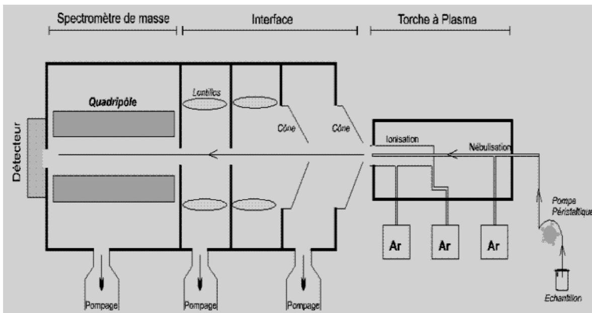
Figure II-5 : Schéma du principe de fonctionnement de l'ICP/MS
