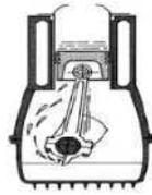
Figure I-1 Graissage par barbotage
