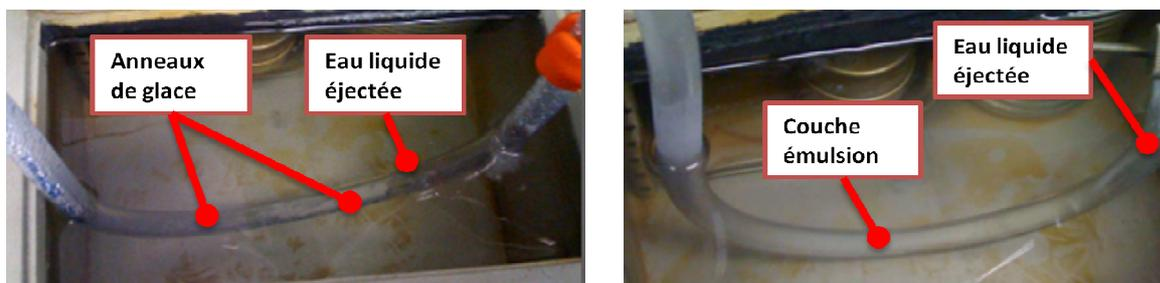
(A) Essai avec air humide pur (B) Essai avec film d'huile pré-refroidi
