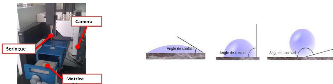
Figure 71 : Méthode de mesure de l'angle de contact (Essai en laboratoire)
