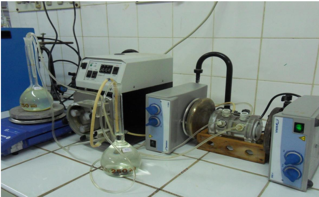
Figure IV- 24 : Montage du procédé obtenu par couplage de la DIC et de l'adsorption sur une alumine activée.
