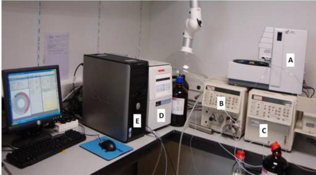
Figure B-2 : chaîne HPLC Varian (INRA Dijon). A: échantillonneur automatisé ; B: pompe; C: détecteur UV ; D: compteur à scintillation en flux continu ( $\beta$  flow-one) ; E : ordinateur de contrôle
