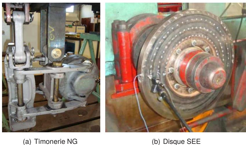
FIGURE 6.1 – Vue des éléments du système réel installés sur le banc d'essai de l'AEF
