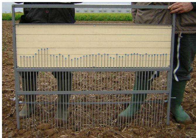
*Figure 1.1 : Photo d'un rugosimètres à aiguilles (Source : thèse Le Morvan 2010)*
