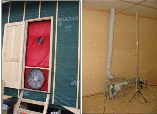
Figure 43 : Photo de la Porte Soufflante (gauche) et du Perméascope<sup>®</sup> (droite)
