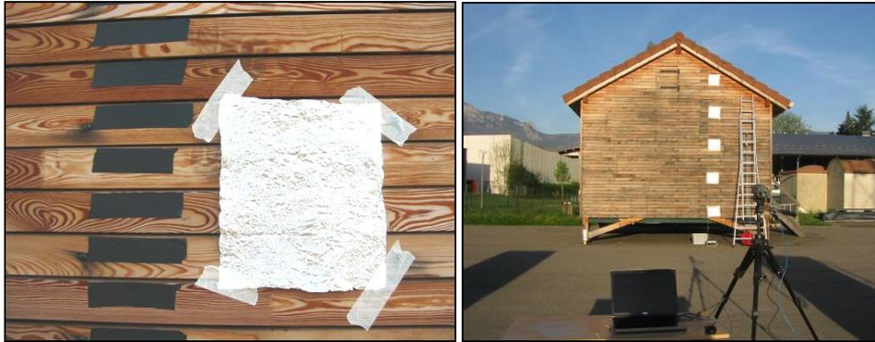
**Figure 23 : Scotch noir et la feuille d'aluminium permettant d'estimer respectivement l'émissivité des lames et la température de l'environnement**
