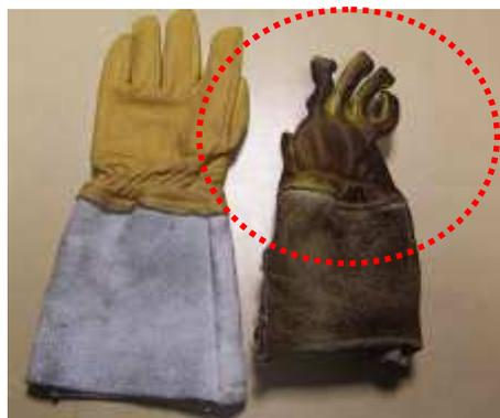
**Figure 3.23 : Gant en cuir, avant et après le flash thermique (Photo BSPP)**
