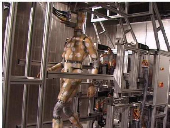
**Figure 2.6 : SAM, mannequin articulé thermique (Photo Empa)**
