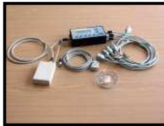
**Figure 4.10: Sondes de température (photo CEB)**
