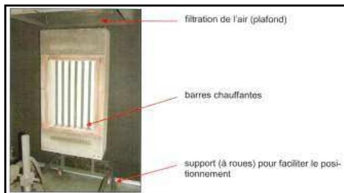
**Figure 3.3 : Source de chaleur radiante (Photo Empa)**
