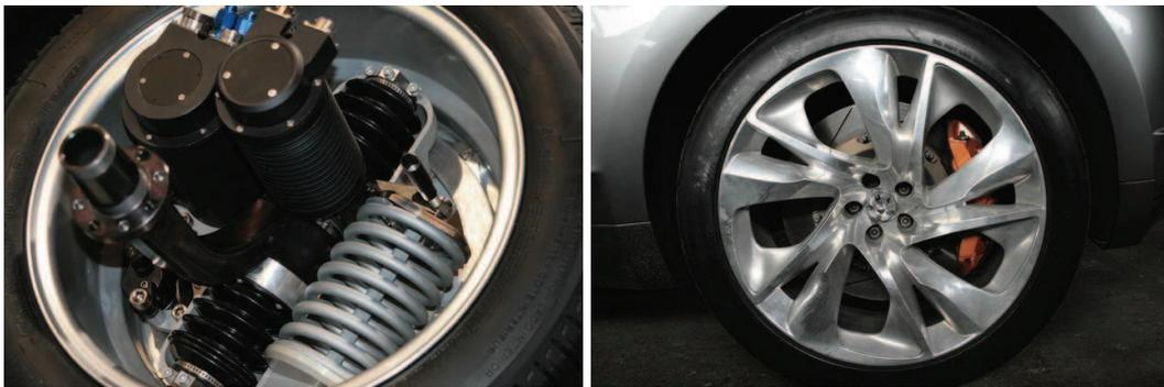
Figure 1.10 – Moteur-roue fabriqué par Michelin [CHA]
