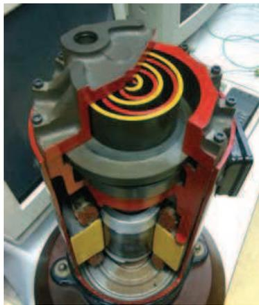
Figure 1.14 – Compresseur à scroll
