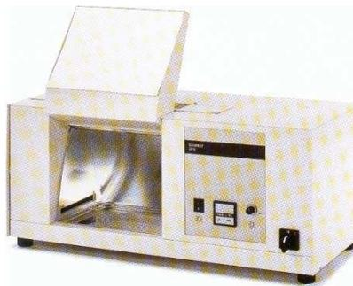
**Schéma (I.20) :** Appareil SUNTEST CPS+.
