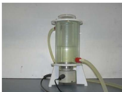
**Schéma (III.10) :** Réacteur ultrasons à 500 kHz.
