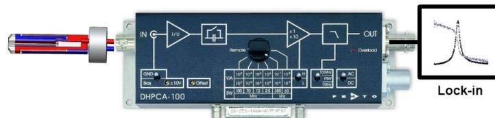
FIGURE 3.21 – Montage pour la mesure du déplacement des bras du diapason.
