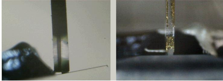
FIGURE B.5 – Le LER est amené au contact de la base du levier. Ainsi le levier se détachera plus facilement du chip.
