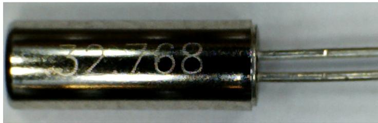
FIGURE 3.2 – Photo du diapason à quartz dans sa capsule.
