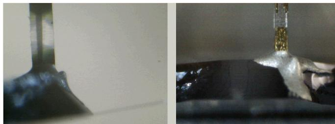
FIGURE B.3 – Une petite quantité de colle conductrice est déposée sur le chip sur lequel le levier est attaché. Le LER est d'abord trempé dans cette colle.
