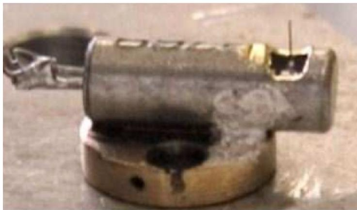
FIGURE 3.3 – Photographie du diapason. Le cylindre a simplement été coupé au dessus d'un des bras avant de collé une pointe en Tungstène [39]
