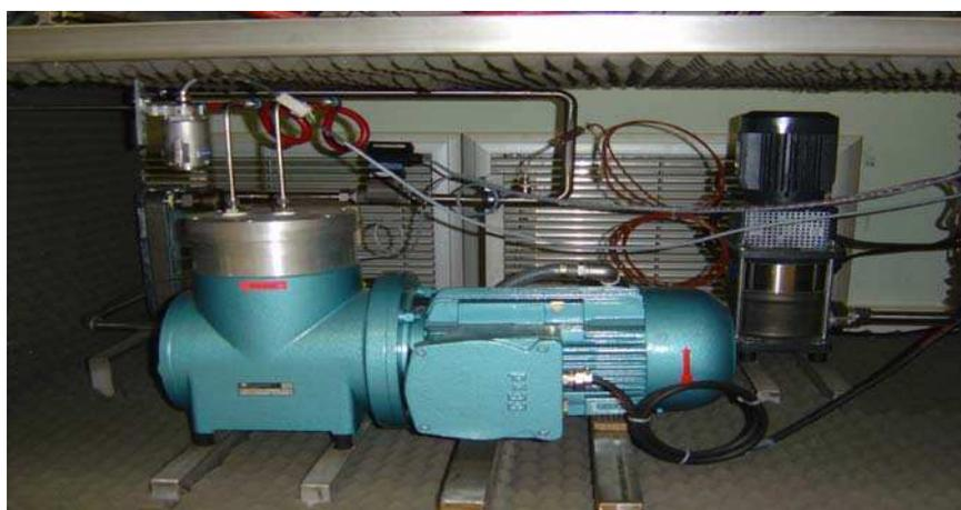
Figure B 5: Compresseur de recirculation
