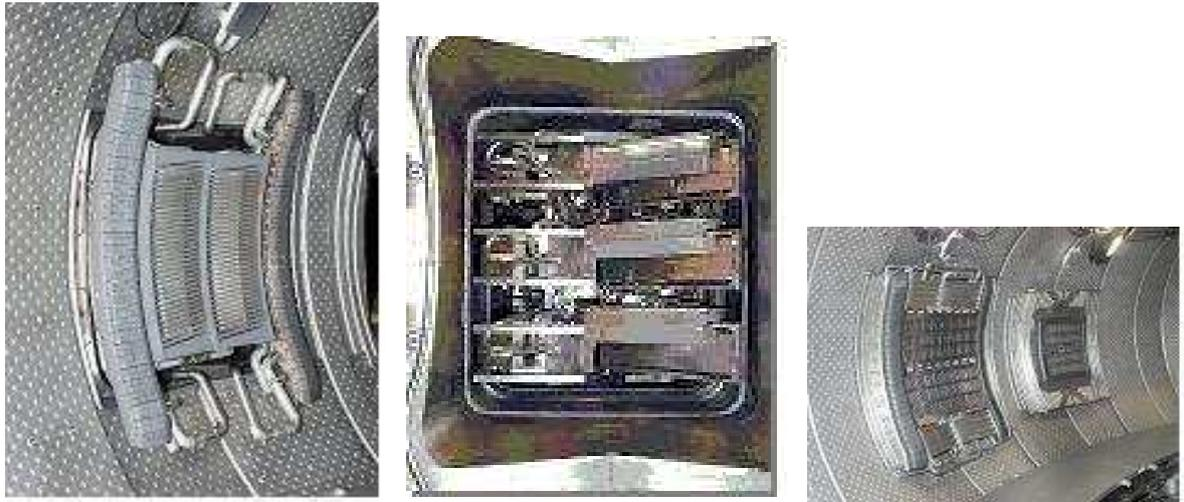
(a) Antenne d'émission d'ondes FCI de Tore Supra (b) Antenne d'émission d'ondes FCE de Tore Supra (c) Antenne d'émission d'ondes HYB de Tore Supra
