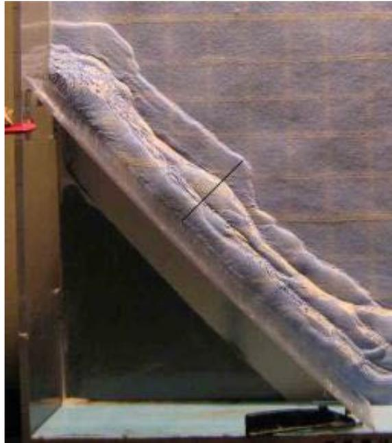
*Figure 2 - 10: Mesure de la distance de propagation du prisme perpendiculairement à la butée oblique de gauche.*
