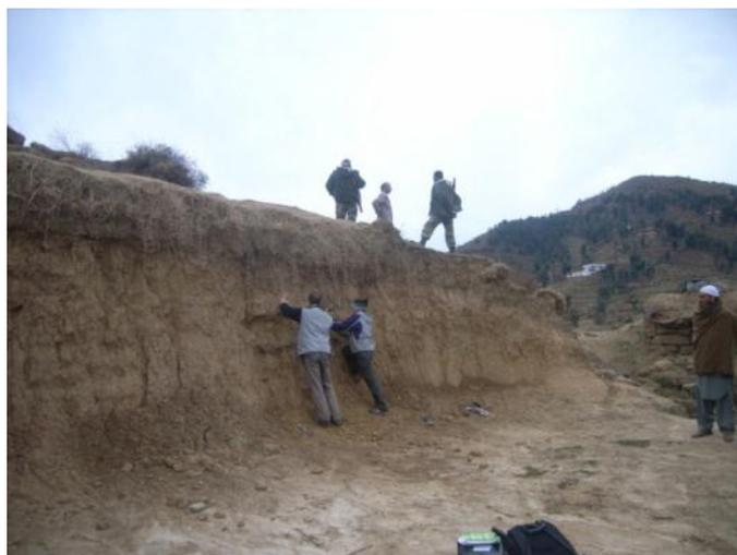
*Figure 3 - 14 : Photographie du dépôt supérieur de la terrasse 1 au moment de l'échantillonnage pour les datations OSL.*
