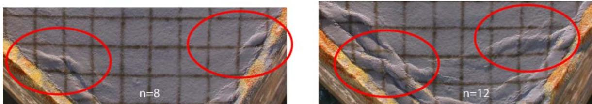
Figure 2 - 33 : Expérience JK 5 : Vue en carte de l'évolution de structures obliques au cours de la convergence. L'échelle est donnée par le quadrillage (5 cm de côté).
