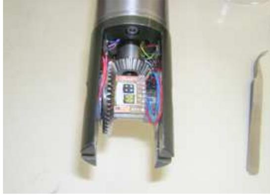
Fig. 2.24. Canne du cryostat et porte-échantillon.
