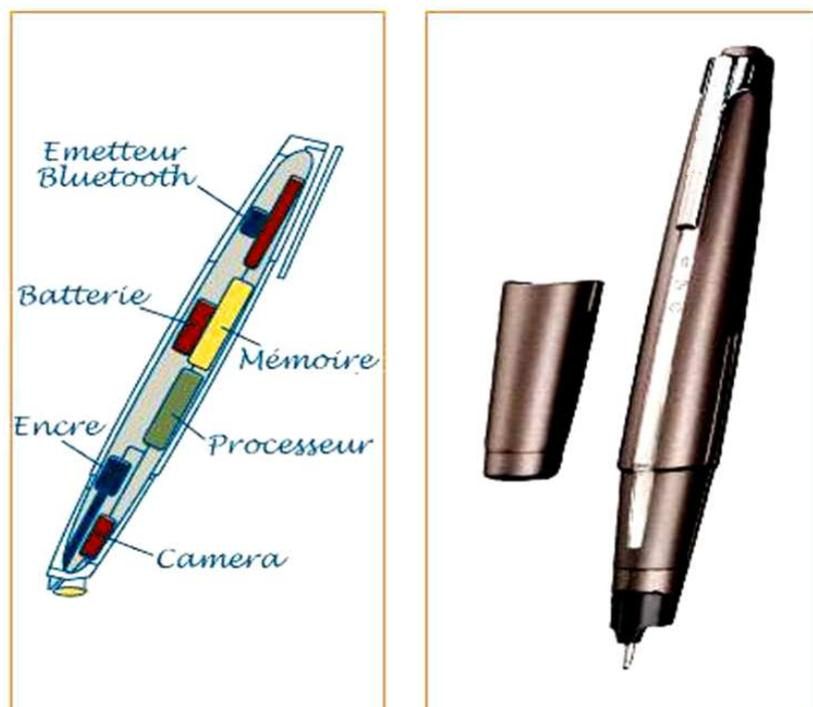
*Illustration 7 : Schéma et photo d'un stylo numérique*
