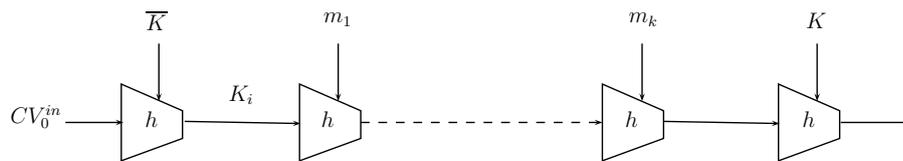
FIGURE 1.7 – La construction *envelope* MAC pour une fonction de hachage  $H$  construite selon l’algorithme de Merkle-Damgård avec une fonction de compression  $h$ .
