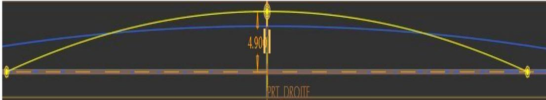
La quatrième voûte horizontale correspond à la largeur la moins grande de la caisse inférieure, je définis les coordonnées :  $A (-82, 3,4)$ ,  $O (0, 4,5)$ ,  $C (82, 3,4)$  et obtiens l'équation de sa parabole :
