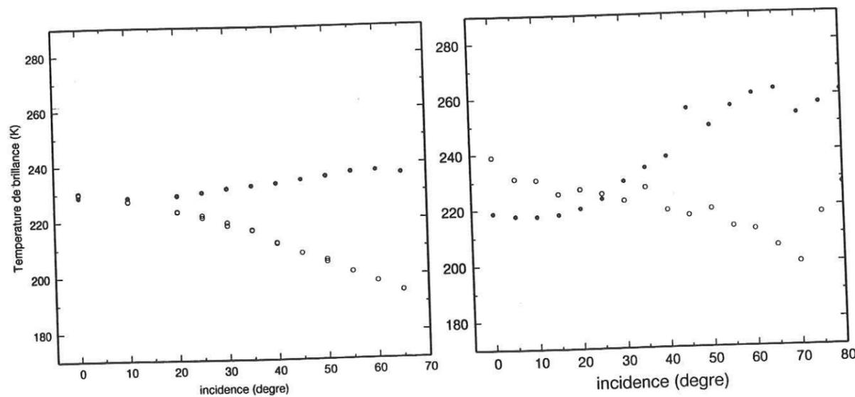
Fig. IV.10 : Températures de brillance mesurées par PORTOS à 5.05 GHz, le 15-01-94 en visée arrière (à gauche) et déconvoluées par le diagramme d'antenne (à droite).
