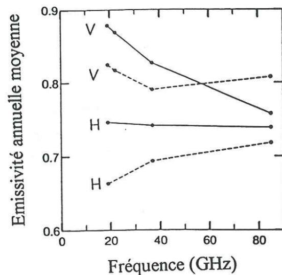
Fig.II.5 : Emissivité annuelle moyenne aux polarisations verticale (V) et horizontale (H), aux fréquences 19, 22, 37 et 85 GHz, à Dôme C (pointillés) et à Lettau (ligne). Les valeurs sont celles de l'année 1989, excepté pour le 85 GHz calculée pour 1988, ce canal ayant cessé de fonctionner en 1989.
