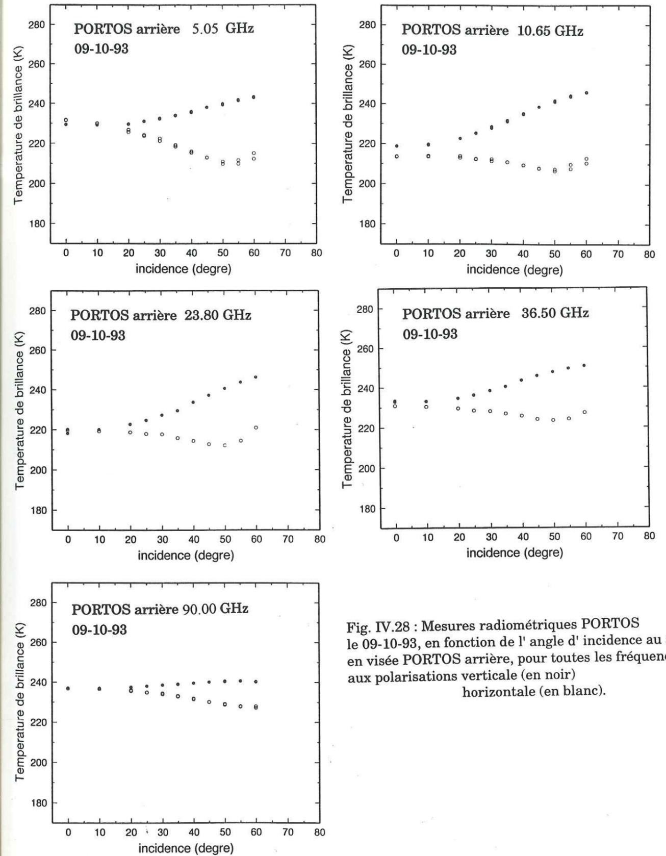
Fig. IV.28 : Mesures radiométriques PORTOS le 09-10-93, en fonction de l' angle d' incidence au sol, en visée PORTOS arrière, pour toutes les fréquences, aux polarisations verticale (en noir) horizontale (en blanc).
