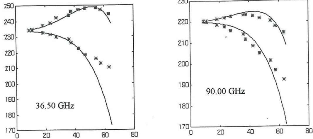
Fig.V.10 : Températures de brillance modélisées (trait plein) et mesurées par PORTOS (\*) à 36.50GHz et 90.00 GHz, le 15-01-94. Les paramètres sont :
