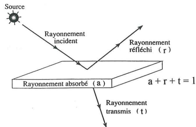
Fig.I.6 : Absorption, réflexion et transmission du rayonnement incident.
