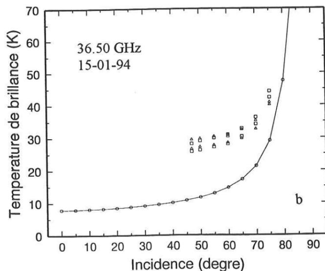
Fig.IV.21: \* Températures de brillance modélisées ciel clair, corrigées du diagramme d'antenne, profil de Chamonix le 15/01: cercle
