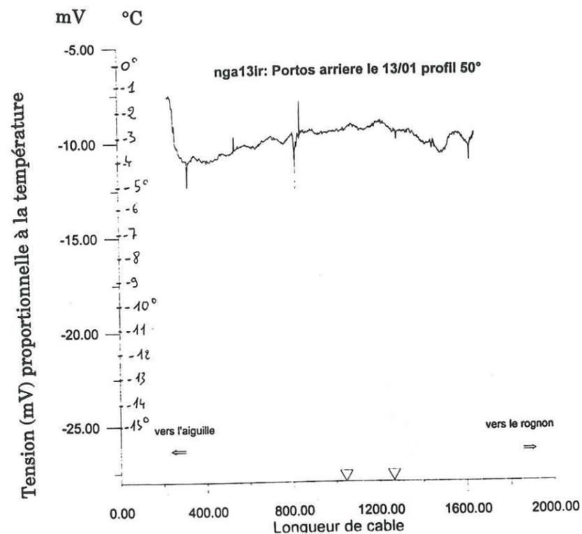
Fig.III.9 : Profil de température radiométrique Infra-Rouge. Les mesures correspondant au site 2 se trouvent sur la courbe entre les deux triangles.
