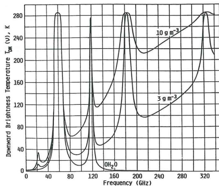
Fig. I.14 : Température de brillance, au zénith, de l'atmosphère  $T_{DN}(v)$  pour différents contenus en vapeur d'eau, et pour une température de 288 K (Smith, 1982, extrait de Ulaby et al., 1981, vol. 3).
