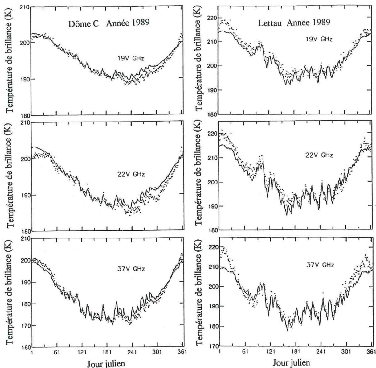
Fig.II.9 : Températures de brillance mesurées (point) et calculées (ligne) aux fréquences 19V, 22V, 37V GHz, à Dôme C, en 1989.
