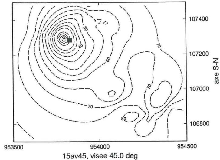
Fig.IV.25 : Courbes iso-niveaux des angles locaux d'incidence au sol (°) pour Portos (carré noir) en visée 45° avant.
