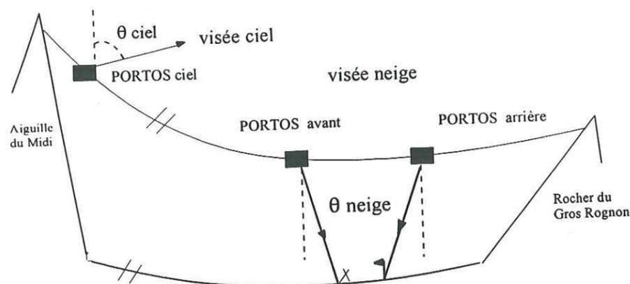
Fig.III.6 : Configuration de mesure neige, en visée PORTOS avant et PORTOS arrière sur le site 2 et configuration de mesure ciel près de la gare.
