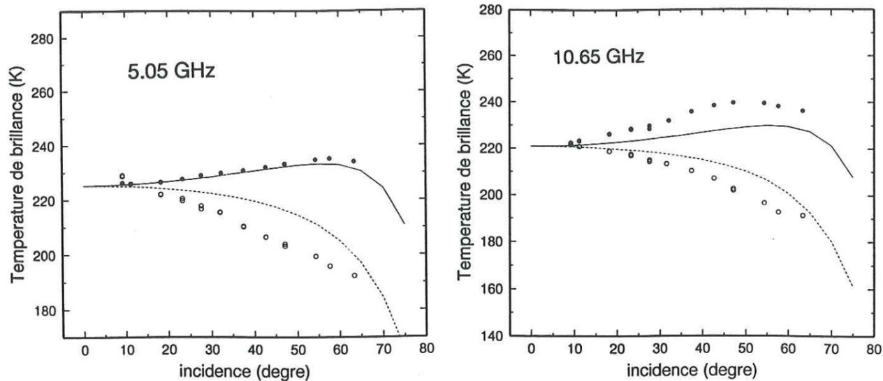
Fig.V.5 : Températures de brillance modélisées (trait plein (V) et pointillé (H)) après ajustement du diamètre des grains pour les fréquences 5.05 et 10.65 GHz. Il est de 1 mm pour la fréquence 5.05 GHz et de 0.63 mm pour la fréquence 10.65 GHz.
