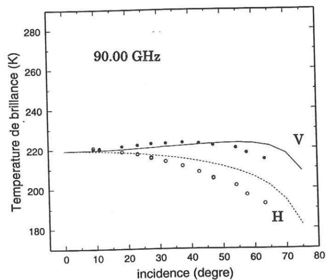
Fig.V.7 : Températures de brillance modélisées (trait plein (V) et pointillé (H)) après ajustement du diamètre des grains pour les fréquences 36.50 et 90.00 GHz. Il est de 0.19mm pour la fréquence 36.50 GHz et de 0.125 mm pour la fréquence 90.00 GHz.
