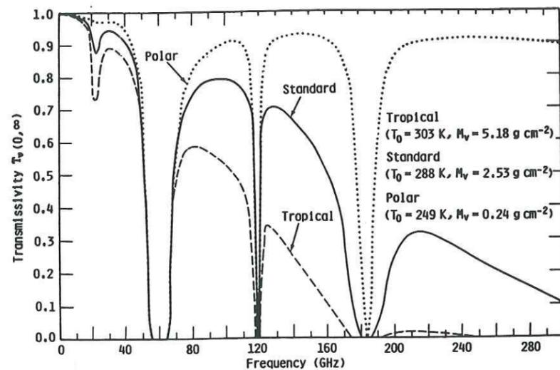
Fig. I.13 : Transmission de l'atmosphère en fonction de la fréquence, pour différentes températures atmosphériques  $T_0$  et contenus en vapeur d'eau  $M_v$  (Grody, 1976 extrait de Ulaby et al., 1981, vol. 3)
