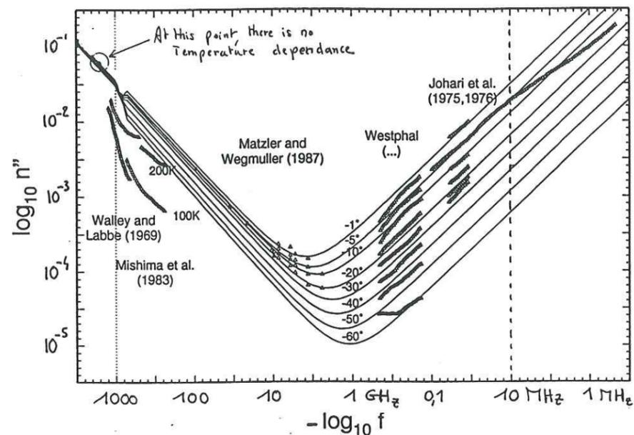
Fig. V.1 : Paramétrisation de la partie imaginaire de l'indice de réfraction de la glace.
