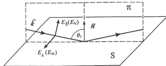
Fig.I.2 : Composantes horizontale et verticale d'une onde plane incidente sur la surface (S).
