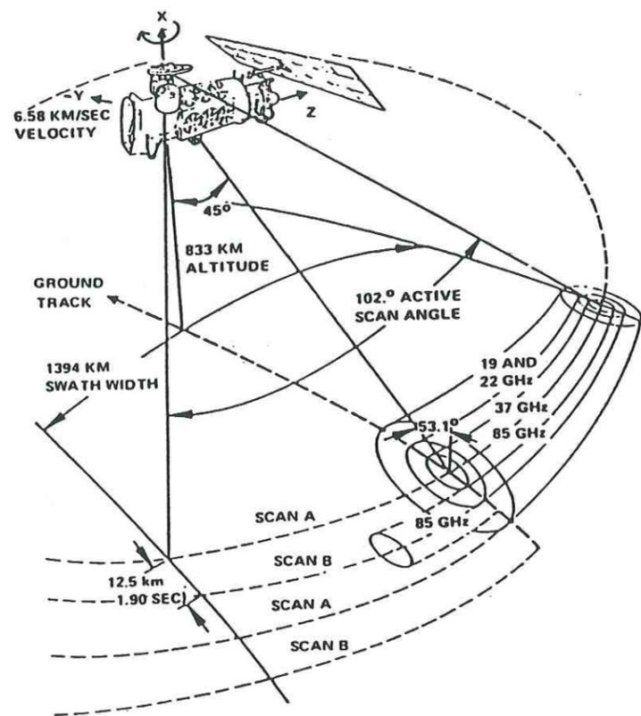
Fig.II.2 : Caractéristiques géométriques de la mesure SSM/I.
