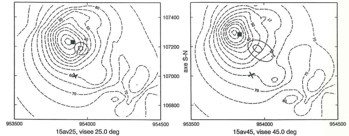
Fig.IV.27 : Courbes iso-niveaux des angles locaux d'incidence au sol ( $^{\circ}$ ) pourPortos (carré noir) en visées 25° et 45° avant et arrière. Les taches au sol aux angles d'ouverture d'antenne -3 dB (12°) et -20 dB (30°) sont représentées en trait plein. L'emplacement du puits à l'extérieur du site de mesure radiométrique, où les mesures de terrain ont été effectuées est indiqué par la croix.
