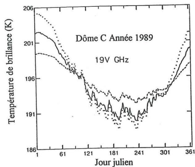
Fig.II.11 : Températures de brillance à 19V GHz calculées pour différents coefficients d'extinction, et pour une conductivité fixée;  $K_e$  est le coefficient d'extinction calculé précédemment  $1.35 \text{ m}^{-1}$  (ligne), puis augmenté de 50% (point) et diminué de 50% (tiret).
