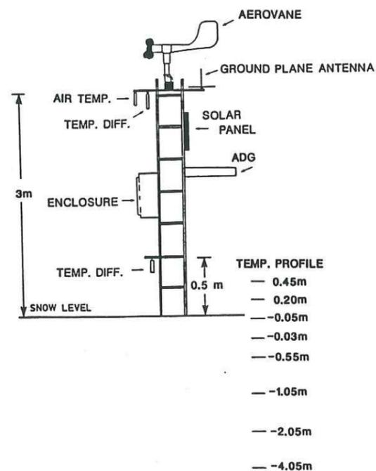
Fig.II.4 : Schéma d'une station automatique AWS.
