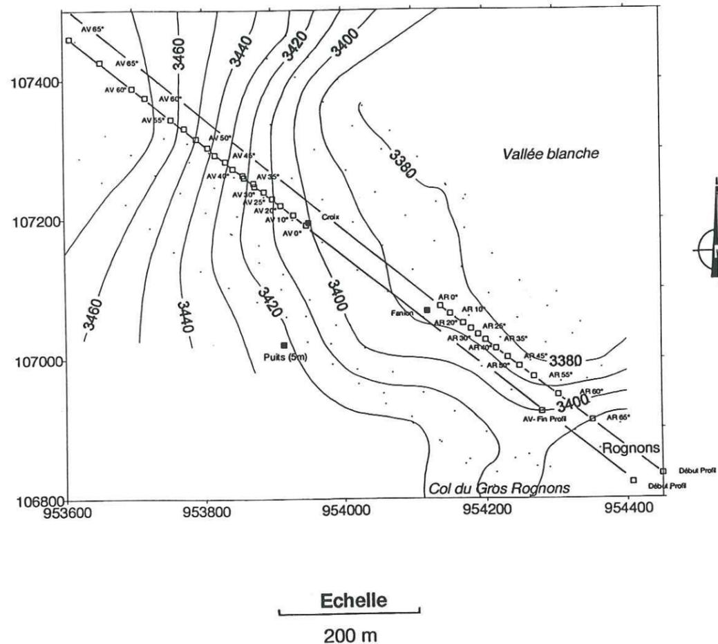
Fig.IV.22 : Topographie du site de mesure dans le système Lambert de l'IGN, positions des cabines pour chaque angle d'incidence en visées arrière (AR) et avant (AV), des repères visés au sol (croix et fanion), du sondage stratigraphique (puits).
