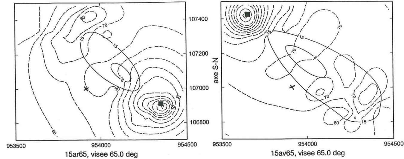
Fig.IV.26 : Courbes iso-niveaux des angles locaux d'incidence au sol ( $^{\circ}$ ) pourPortos (carré noir) en visées 55° et 65° avant et arrière. Les taches au sol aux angles d'ouverture d'antenne -3 dB (12°) et -20 dB (30°) sont représentées en trait plein. L'emplacement du puits à l'extérieur du site de mesure radiométrique, où les mesures de terrain ont été effectuées est indiqué par la croix.
