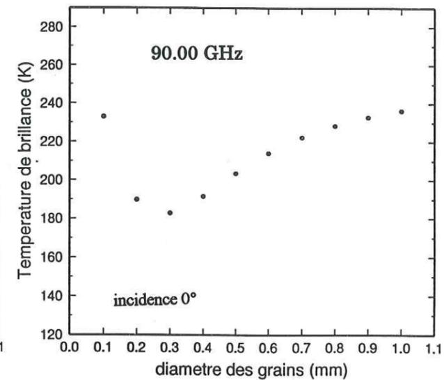
Fig.V.3 : Température de brillance au nadir en fonction du diamètre des grains. Les caractéristiques de la neige pour chaque fréquence sont celles du tableau V.3.
