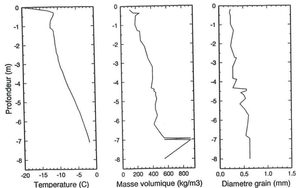
Fig.III.12 : Profils de température, de densité et de diamètre convexe des grains, le 15-01-94.
