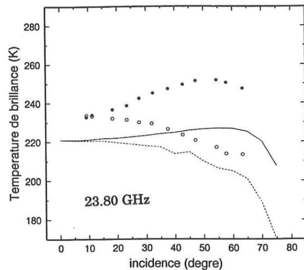
Fig.V.8 : Températures de brillance modélisées avec le modèle en milieu stratifié, en fonction de l' angle d' incidence, pour la fréquence 23.80 GHz.
