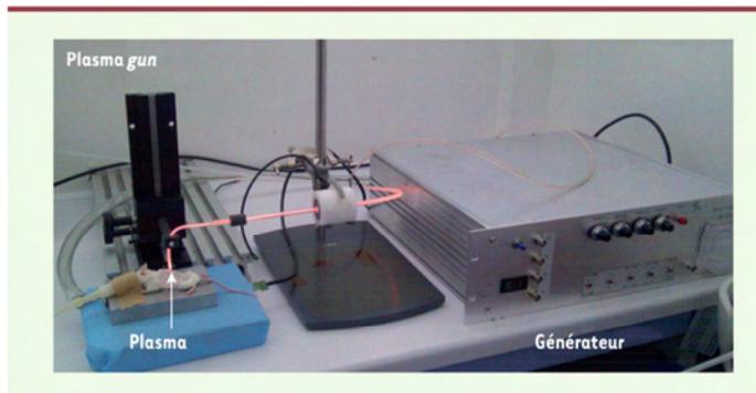
Figure 2. Photo de l'ensemble du dispositif plasma gun.
