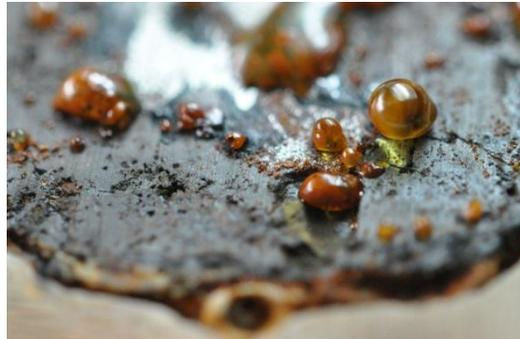
Figure 1 : Formation de gouttelettes de produits de corrosion formées à la surface d'un objet archéologique remis à l'air (lingot de fer), site des Saintes Maries de la Mer [7]
