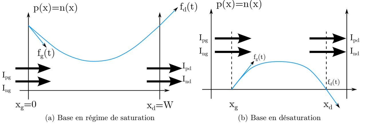
FIGURE 1.7 – Répartition des porteurs dans la région de base profonde et faiblement dopée.
