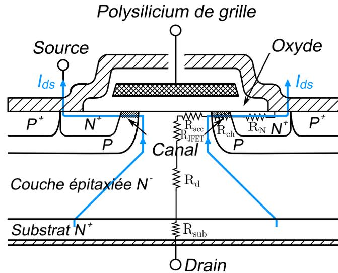
FIGURE A.2 – Coupe schématique d'un transistor VDMOS.
