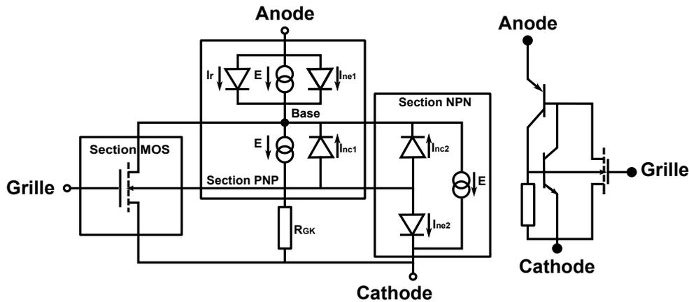
FIGURE 1.8 – Schéma électrique équivalent d'une structure thyristor MOS.
