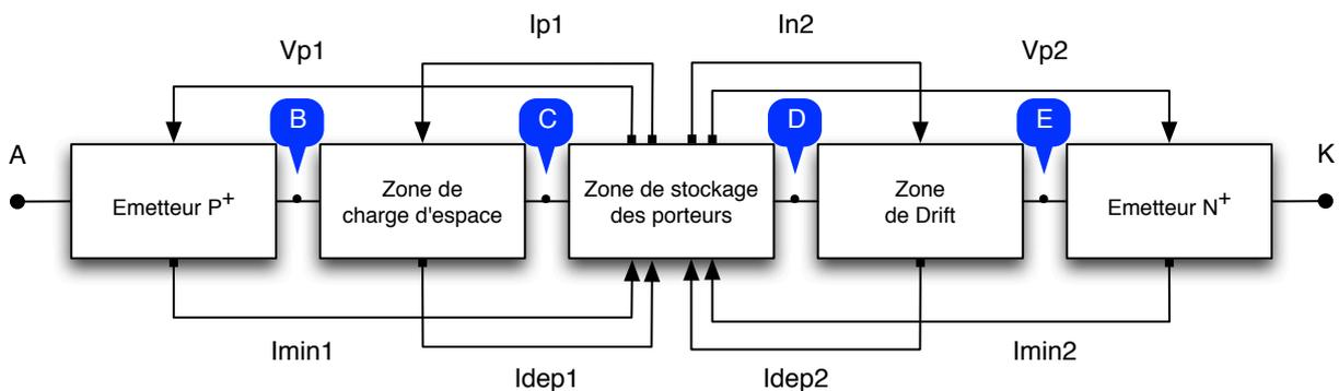
FIGURE 3.6 – Les différentes connexions entre les sous modèles formant le modèle VHDL-AMS de la diode PIN.
