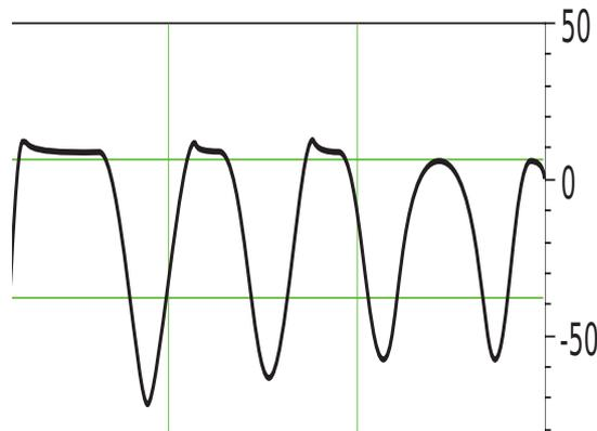
(c) Pics de tension présentés sur les résultats de simulations de la diode pour  $\tau = 41$  ns à  $T=400$  K
