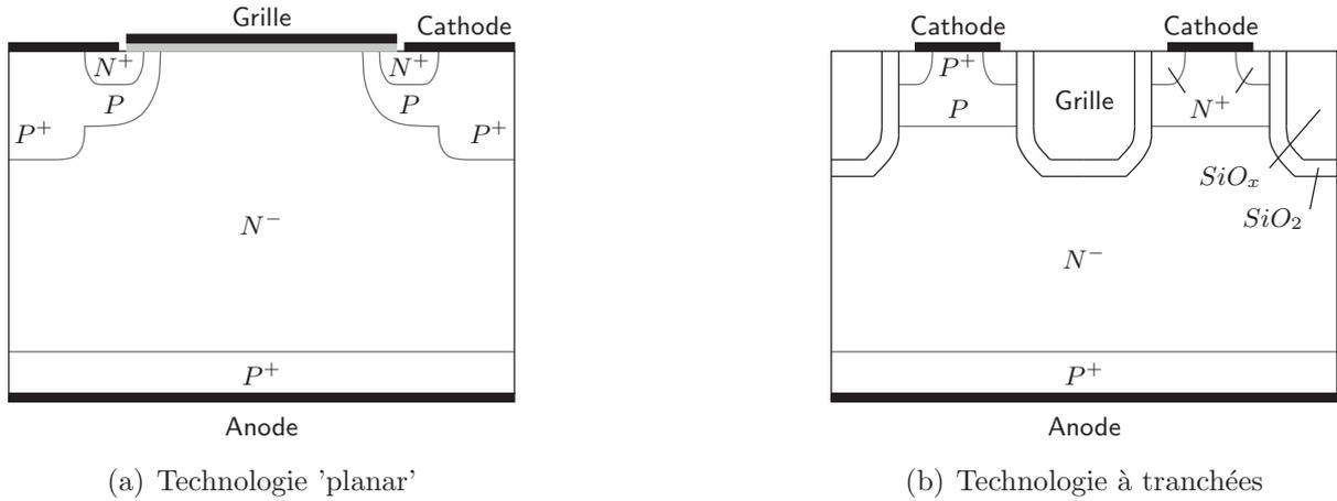
FIGURE 1.3 – Représentation des structures planar et à tranchées.
