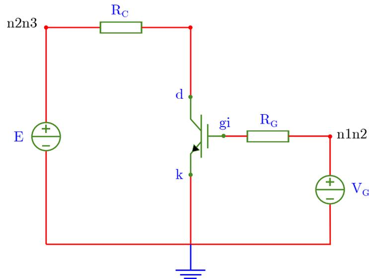
FIGURE 3.20 – Présentation du circuit électrique de test utilisé pour simuler les caractéristiques de sortie statiques  $I_{AK}(V_{AK})$  de l'IGBT-NPT.
