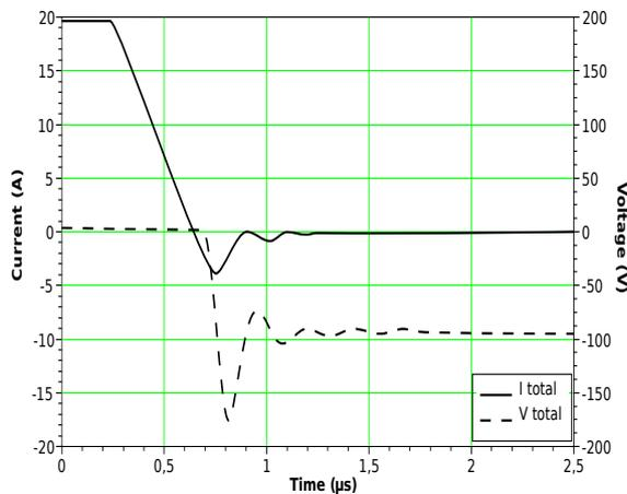
(a) Résultats de simulation du modèle VHDL-AMS de la diode PIN à contrôle d'injection sous Questa-ADMS à  $T=300$  K
