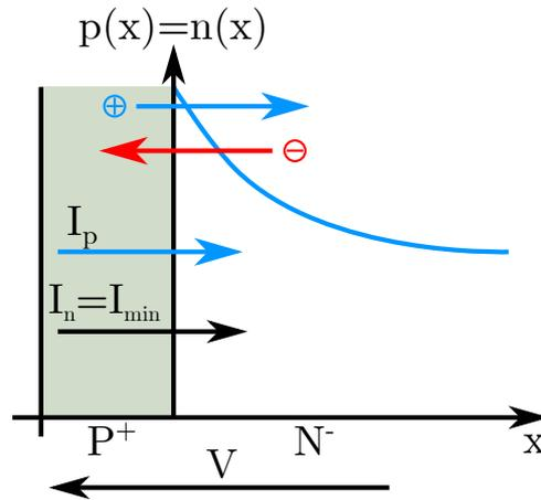
FIGURE 2.4 – Mécanisme de transport de charge à la jonction émettrice.
