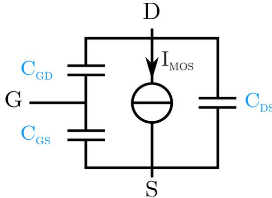
FIGURE 2.6 – Schéma équivalent de la section MOS.
