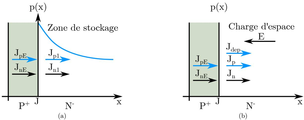
FIGURE 3.1 – (a) Continuité des courants et du produit  $pn$  à l'interface émetteur P<sup>+</sup>/zone de stockage des porteurs. (b) Continuité des courants à l'interface émetteur P<sup>+</sup>/zone de charge d'espace.
