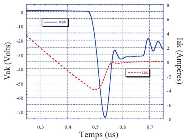
(d) Résultats de simulation du modèle MAST de la diode PIN sous SABER à  $T=400$  K
