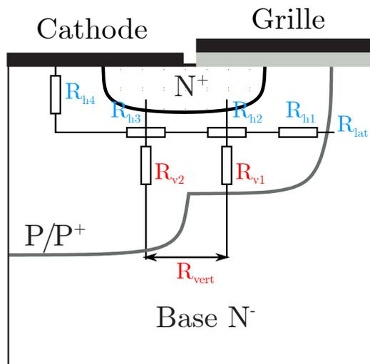
FIGURE 2.8 – Modélisation des résistances du caisson P/P<sup>+</sup>
