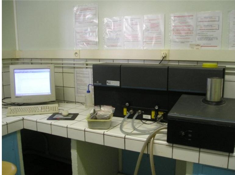
Figure 3.12 Le granulomètre Coulter LS 230
