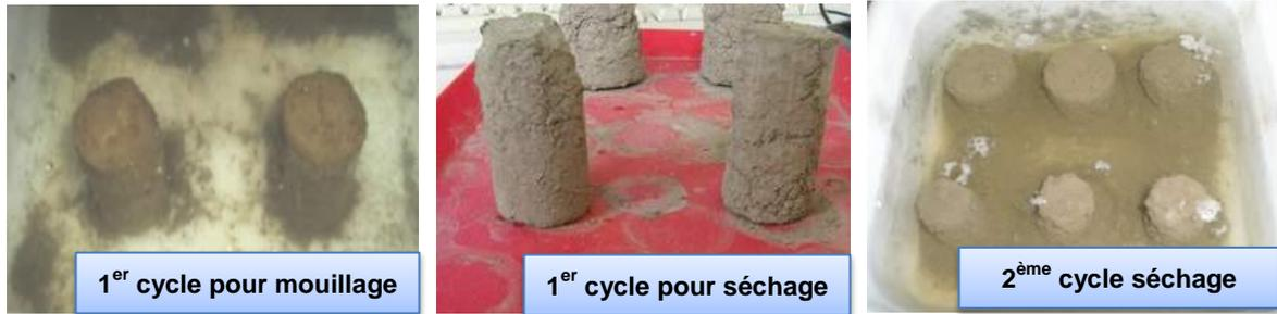
Figure 5.48 Exemples d'endommagement d'échantillons traités à base de ciment, de chaux et de CV sans fibres soumis à l'essai de mouillage-séchage
