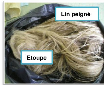
Figure 3.37 Fibres de lin utilisées
