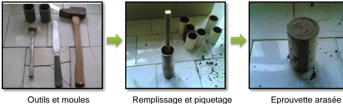
Figure 4.10 Compactage et confection des éprouvettes par piquetage
