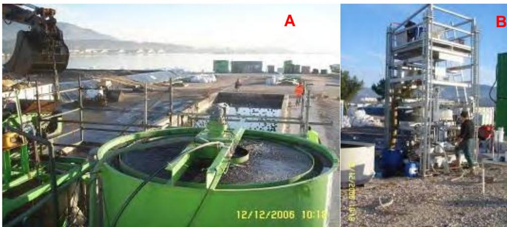
Figure 3.4 Machines de pré-traitement : dessableur (A) filtre presse (B), (Sannier, 2008)
