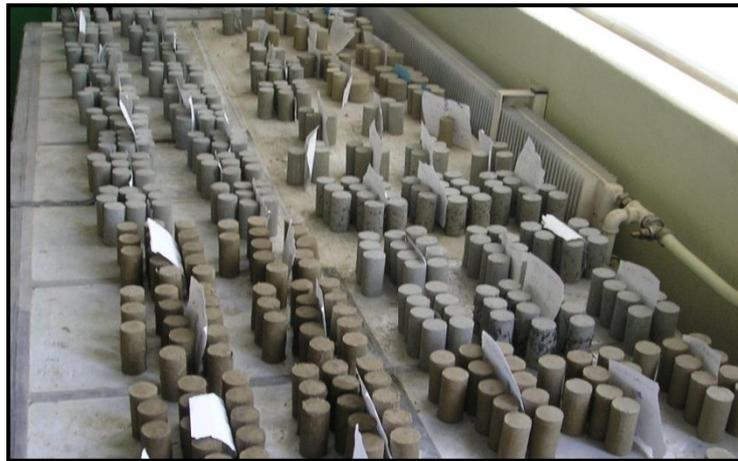
Figure 4.11 Conservation des éprouvettes sur paillasse
