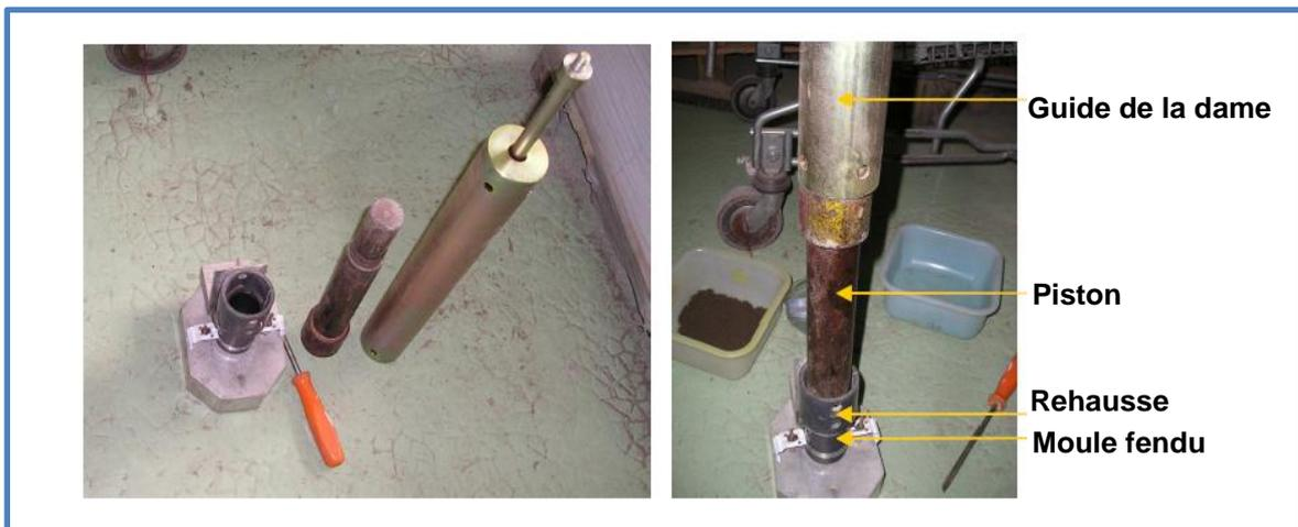
Figure 4.9 Compactage et confection des éprouvettes à la dame Proctor
