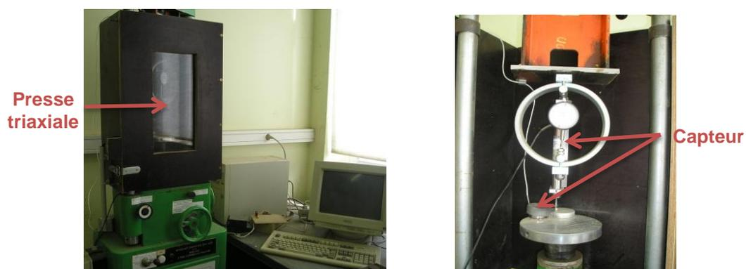
Figure 4.12 Dispositif et moyen de mesures d'un essai de compression
