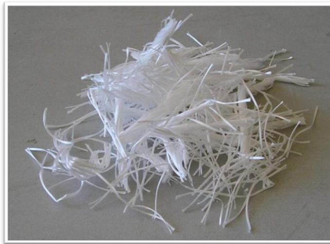
Figure 3.39 Aspect des fibres CHRYSO®Fibre S50
