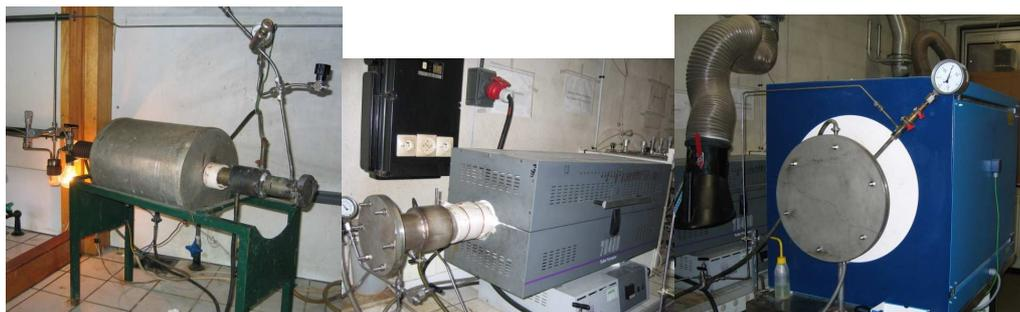
**Figure 2 : Photos des installations à différentes échelles : four à l'échelle de laboratoire, deux fours pour des études préindustrielles.**
